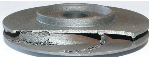
Figure 1 : Cavitation damage to an impellor (Wikicommons – User:Benutzer:Klausbärbel)
